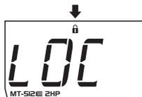
Para desbloquear, desligue o controlador e volte a ligá-lo com a tecla **F** pressionada. Mantenha a tecla pressionada até que a mensagem **LOC** apareça. Ao soltar a tecla, a mensagem **DEFr** será exibida no display.
